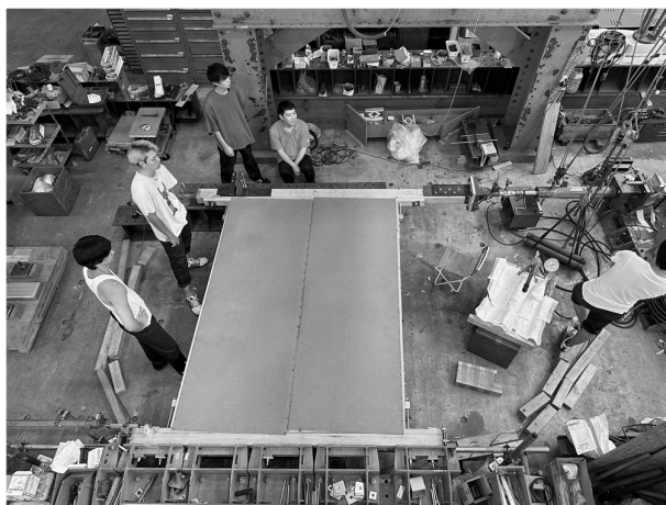
100kN 木質耐力壁試験機（6号館）
