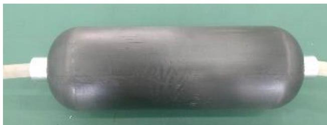
図 3 内圧成形法で成形した CFRP 製タンク
