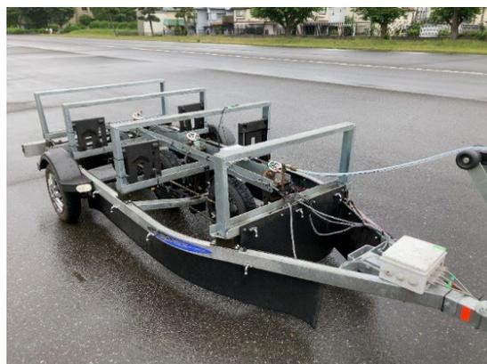
路面摩擦特性計測システム
