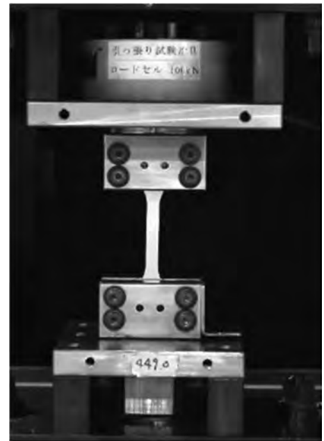
図2 高速引張試験装置
