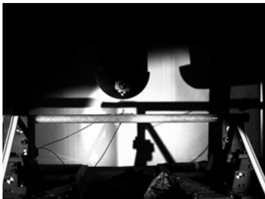
図 1 左の写真はドアインパクトビーム用 FRP 円筒の衝撃実験の様子。右の写真はクラッシュボックス用 FRP 円筒の衝撃実験の様子。破壊は FRP 特有の連続脆性破壊となっている。
