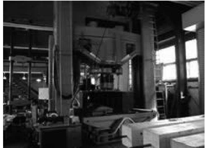
5000kN 構造物試験機（11号館）
