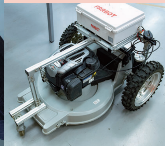
遠隔操作で草刈りを行うロボット「FARBOT モア」
