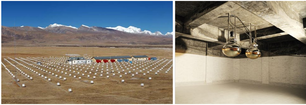
図 1 チベット高原・標高 4300 m に設置されている空気シャワー観測装置(左)とその地下に設置されている注水前の水チェレンコフ型ミュオン検出器(右)。
