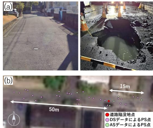
Fig.4 (a)道路陥没前後の状況と(b)DS、及びAS で推定した付近のPS点の分布
