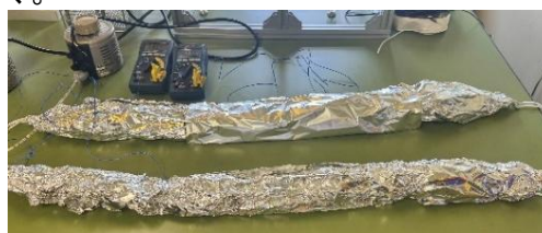
Fig. 8 リボンヒーター使用例
