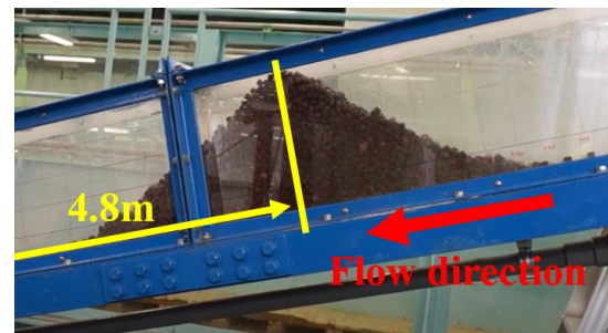
Photo 2 土砂敷設状況
