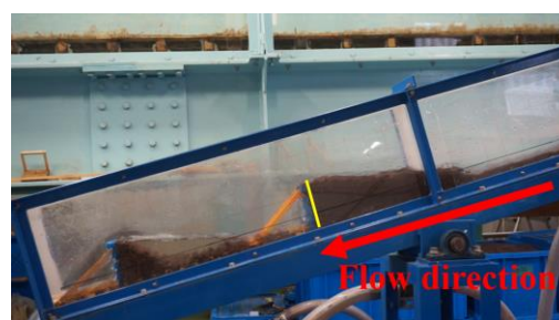
Photo 3 A1土砂捕捉状況
