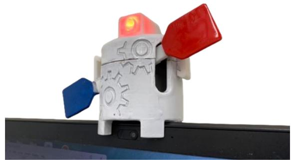
Fig. 1 開発した小型パートナーロボット Flabo の外観
