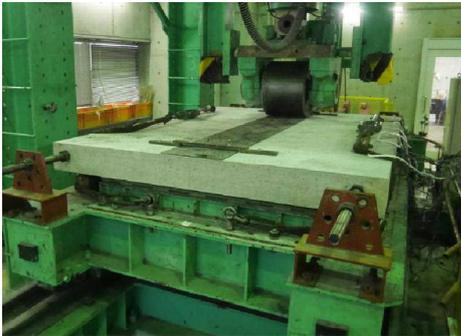
図-2 輪荷重走行・疲労実験状況
