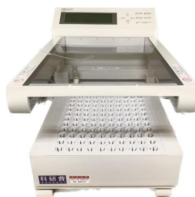
図2. フラクションコレクターCHF122SC (アドバンテック東洋株式会社)
