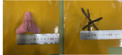
Photo 1 コンクリートブロック模型(左)と、木製模型(右)
