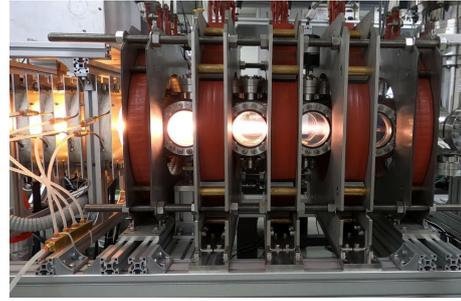
図5 高密度ヘリコン波プラズマ実験装置。
