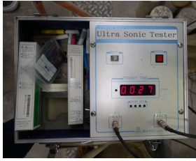
写真-1 超音波非破壊試験機
