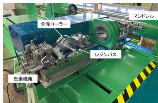
図 1 CFRP 円筒の FW 成形
