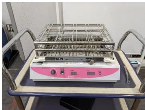
図.2 振とう培養器 (EYELA 製)
