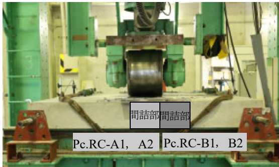
図-3 輪荷重走行疲労試験の状況
