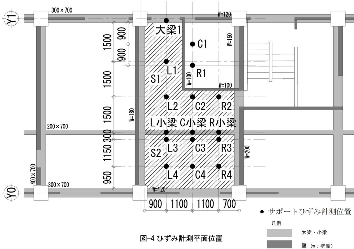
図-4 ひずみ計測平面位置
