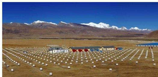
Fig.1 チベット AS $\gamma$ 実験の空気シャワー観測装置(Tibet-III)。白い四角は $0.5 \text{ m}^2$ シンチレーション検出器。
