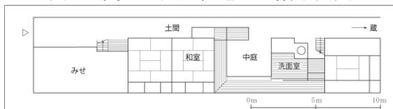
図5 間口が狭い住宅 一階平面図
