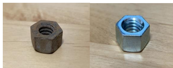
図 1 錆びありナット 図 2 錆び無しナット
