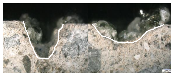
DFS100mm 照射角度90° 照射回数3回 気中状態 DFS150mm 照射角度90° 照射回数3回 気中状態 写真1 DFSが異なる供試体断面
