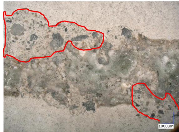
写真3 爆裂した供試体表面
