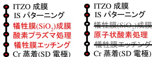
図2 酸素プラズマ処理及び原子状酸素による素子作成工程
