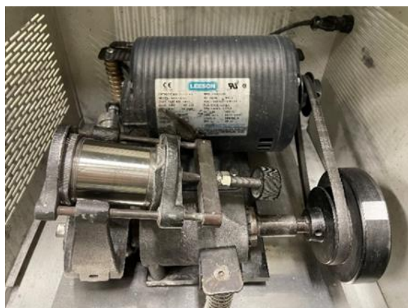
Fig. 2 MA処理に使用する振動型ボールミルの内部および工具鋼製容器
