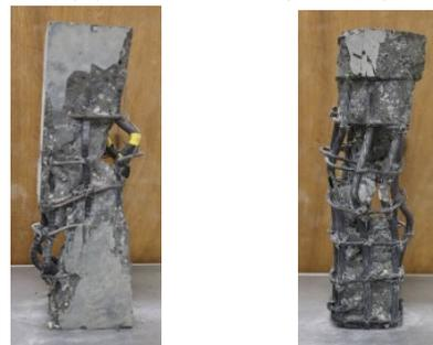
(a) SD 材柱 (b) SBPD 材柱
