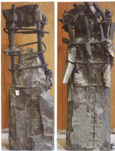
写真-5 RC柱の典型的な圧縮破壊モード
