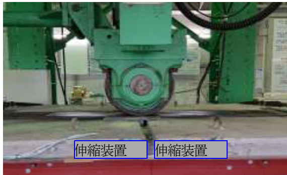
写真－１ 輪荷重走行疲労実験状況
