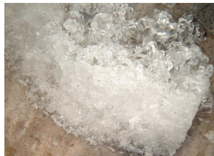
写真 1 促進耐候性試験(B 塗装有り) 4 週目の白華の結晶
