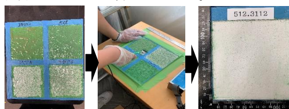
剥離剤塗布 除去作業 除去面評価
