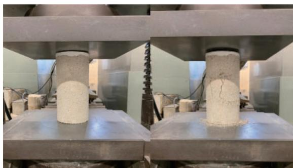
写真2 圧縮強度試験の様子(左:載荷前 右:載荷後)
