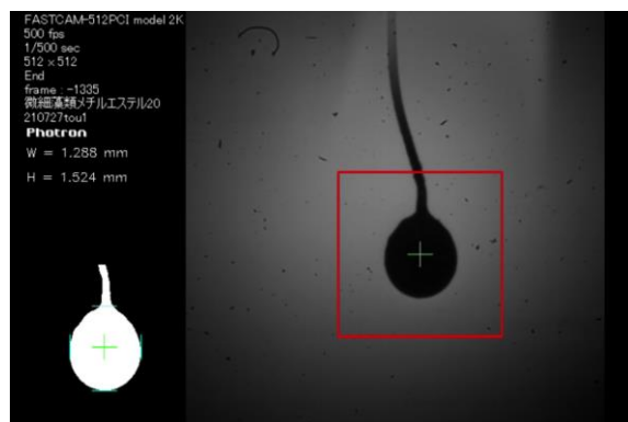
図2 液滴燃焼過程の液滴直径解析
