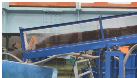
写真-2 土石流の波形 (河床勾配 10°、流量 3968 cm 3 /s)
