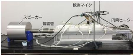
Fig. 1 高温吸音率測定装置外観
