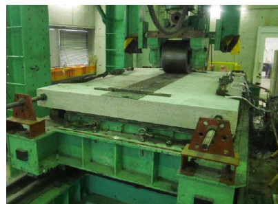
写真-3 輪荷重走行疲労実験
