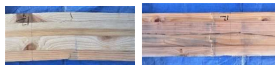
写真-2 中心圧縮実験における破壊性状
