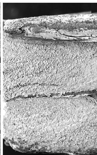
図5 荷重を付加して再熔融した試料断面
