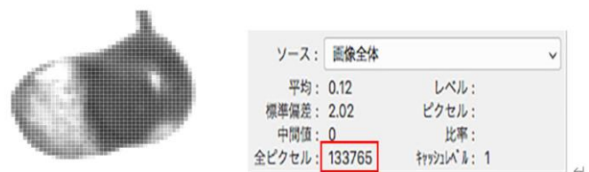
Fig.2 Photoshopを用いた液滴面積の計測
