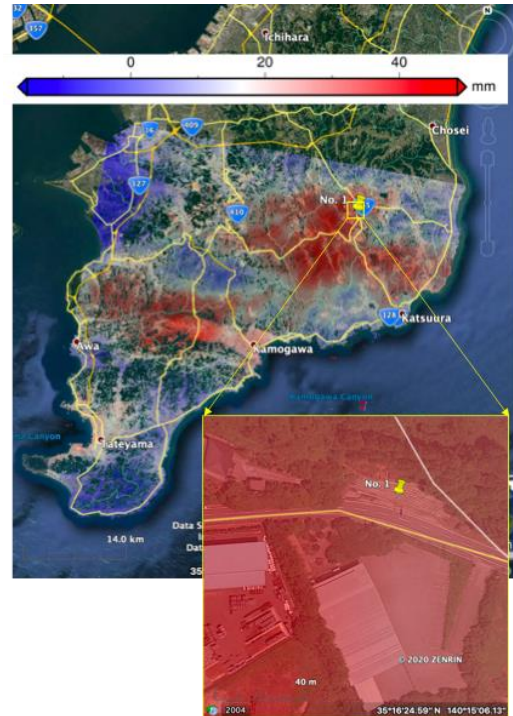
図-3 衛星視線方向の地盤変動量 (LOS画像)
