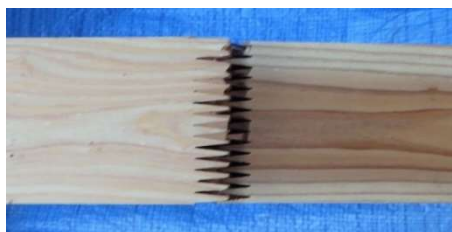
写真-1 CHGT-a の破壊状況
