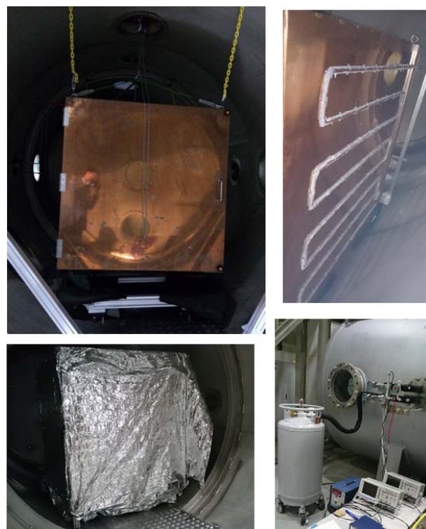
図4 LINCSの冷却設備
