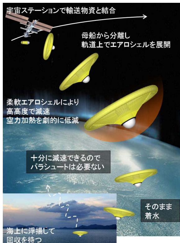
図1 大気圏再突入技術としての展開型エアロシェルの概要
