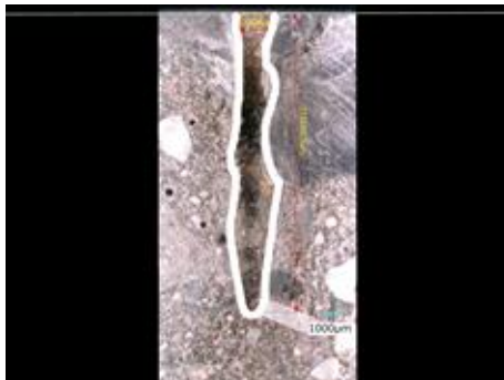
写真2 5Hzの穿孔例（石灰岩）
