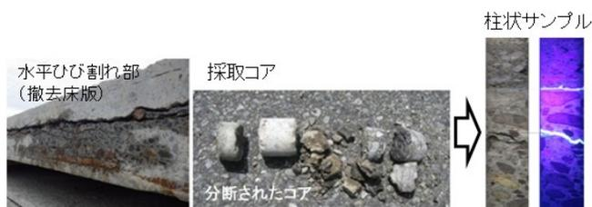
図-1 撤去床版の水平ひび割れと採取コア
