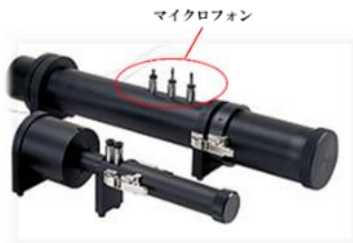
Fig.2 音響管（小野測器-2 マイクロフォン法垂直入射吸音率計測ソフトウェアより）
