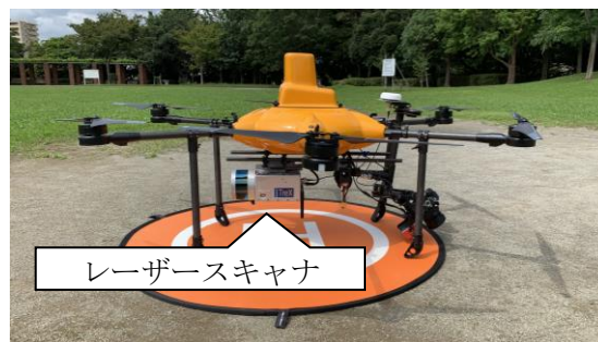
Fig.1 UAV 外観写真
