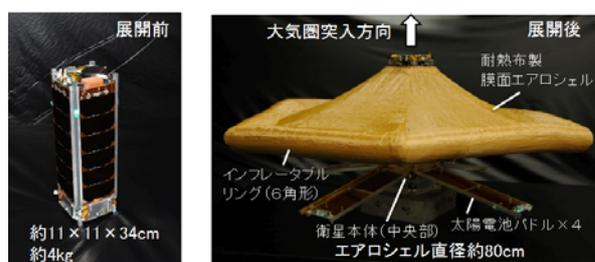
図1 EGGの概観図<sup>6)</sup>
