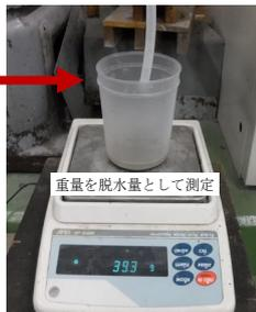
図.3 脱水量の測定
