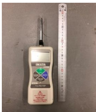
写真2 荷重測定メーター
