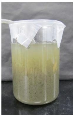
写真-2 活性汚泥によるバッチ処理
