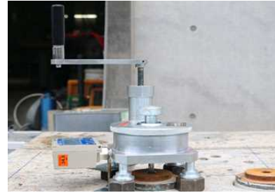
写真-3 建研引張試験
